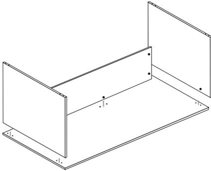
Sistemare ora il telaio così ottenuto, composto dai fianchi dx e sx (2 e 3) e dalla tramezza (4), sul coperchio, infilandolo sui perni per eccentrico (5) inseriti precedentemente.
