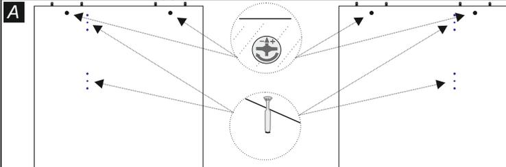
Posizionare i fianchi dx (2) e sx (3) su una superficie piana, con i fori rivolti verso l'alto. Inserire i perni (5) e gli eccentrici (6) sui fianchi. Gli eccentrici vanno inseriti con la freccia rivolta verso il bordo più vicino come mostrato in figura. Avvitare i perni sino a fine corsa.
