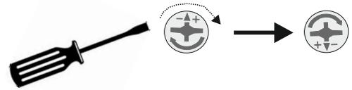
Ruotare gli eccentrici (6) posizionati sulla tramezza (4) e fianchi dx/sx (2 e 3) in senso orario in modo da fissare il coperchio alla tramezza ed ai fianchi.
