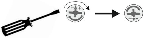
Ruotare gli eccentrici (6) posizionati sulla tramezza (4) in senso orario in modo da fissare la tramezza ai fianchi.
